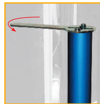
Usare la chiave per svitare il tappo dell'Hyperfilter. Use the spanner to unscrew the Hyperfilter plug.
